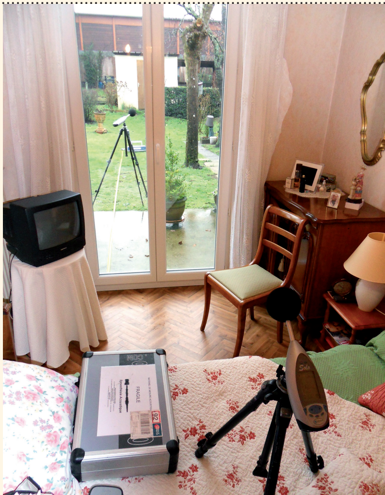
Dispositif de test d'une menuiserie acoustique
