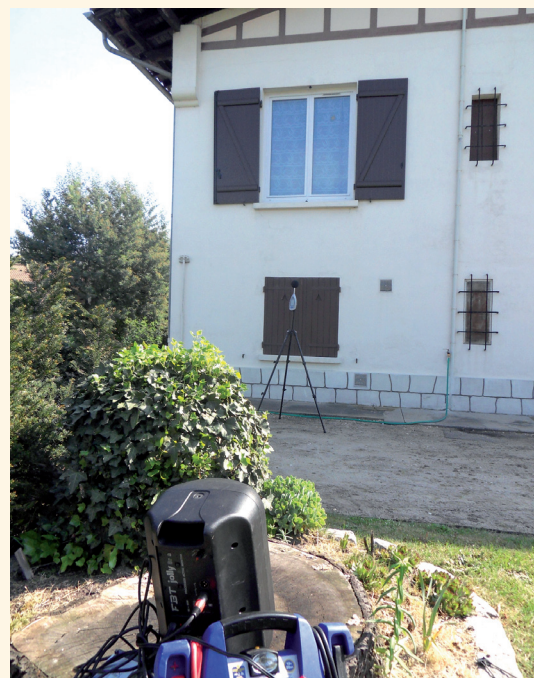
Dispositif de test d'une menuiserie acoustique
