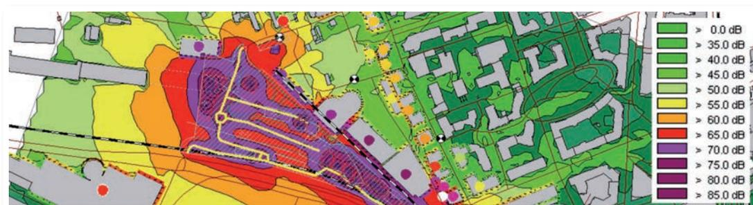
Cartographie sonore réalisée avec le logiciel CadnaA de DataKustik
